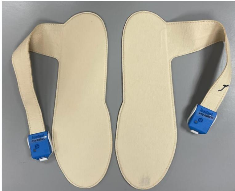
**Figure B-2. Loadsol Load Sensors.**
